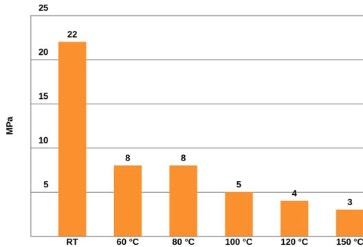
Druckscherfestigkeit nach Medienlagerung für 1000 h, DELO-Norm 5
