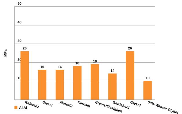
Zugscherfestigkeit für die Bestimmung des Aushärtungsprozesses
