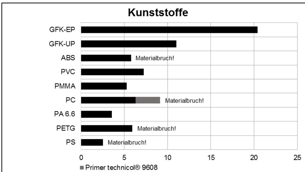
Vorbehandlung: Prüfkörper gereinigt, Metalle sandgestrahlt. Kunststoffe und verzinkte Metalle leicht angeraut. Prüfung bei Raumtemperatur.
